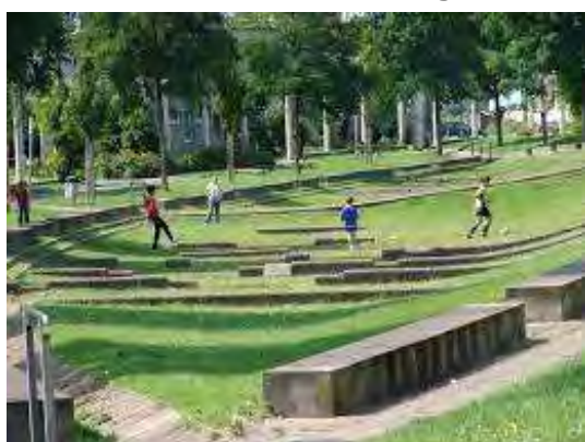
Figure 8 : Exemple de bassin à sec
