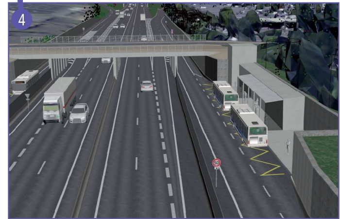
Connexion avec le réseau de tramway : station d'arrêt (Eluard) pour les bus sur l'autoroute
