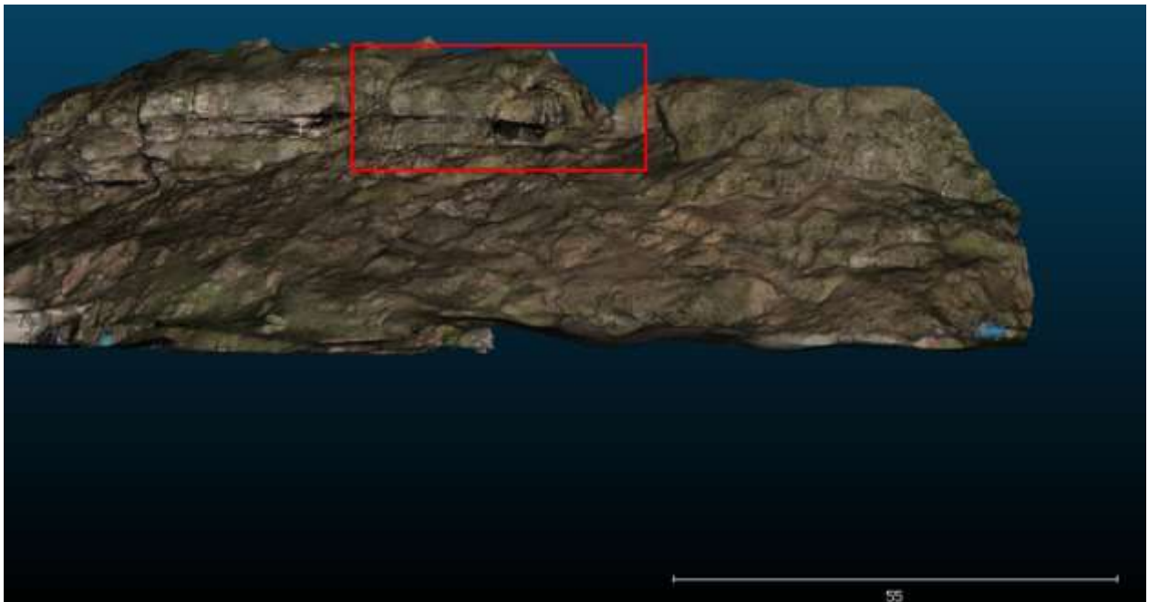
Illustration 30 : Identification d'une zone de départ, cachée par la végétation sur le terrain, mais visible sur le levé LIDAR (encadré rouge)
