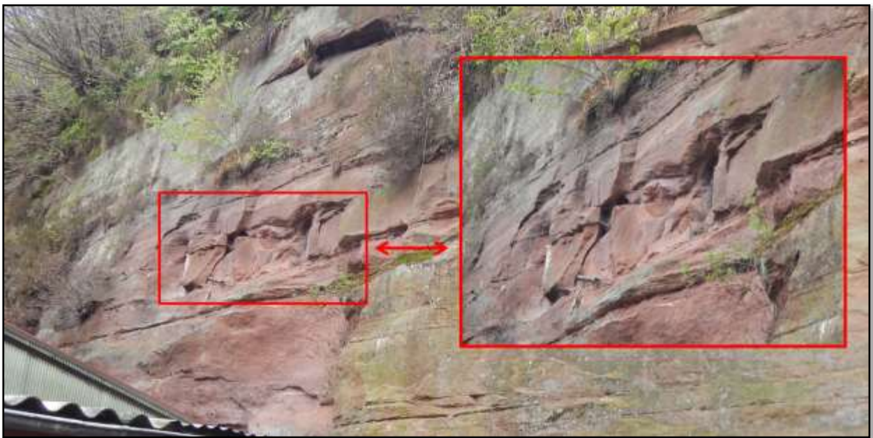
Illustration 24 : Exemple d'une zone de départ présentant une rupture de type glissement dièdre (encadré rouge)
