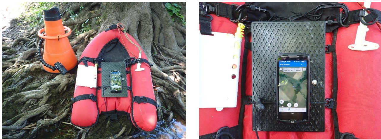
Figure 6 : Enregistrement du parcours et de la durée de l'inventaire via l'application my tracks
